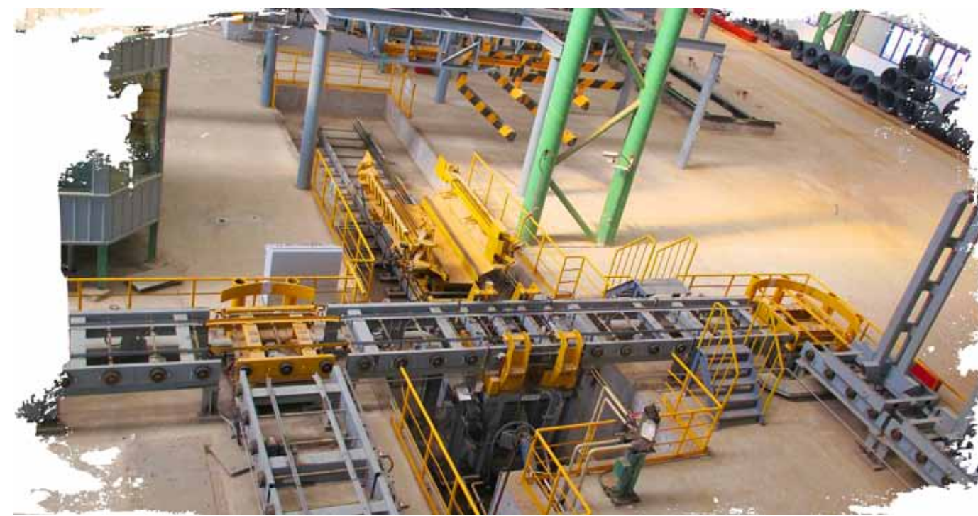
1-集卷站集卷筒；2-集卷站线圈托板装置；3-升降机；4-立式卷芯架；5-回转台；6-标准轮式运输模块；7-翻卷机；8-运卷小车
